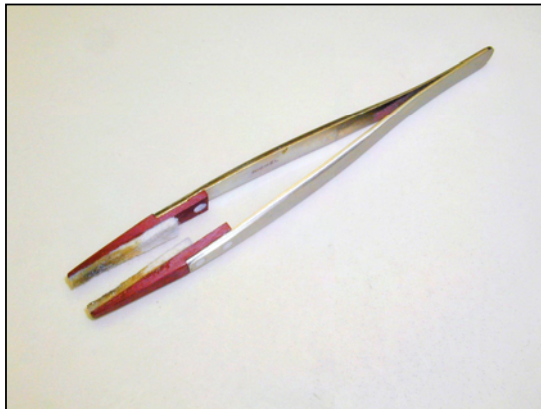
Tweezers for lubricating mainsprings
